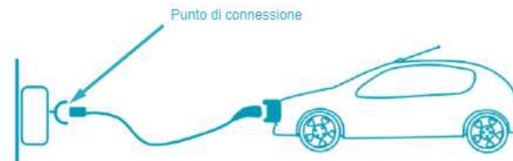
Figura 2 – Punto di connessione costituito da una presa fissa che è parte di un EVSE installato in modo fisso
