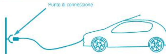
Figura 1 – Punto di connessione costituito da una presa fissa che non è parte di un EVSE installato in modo fisso
